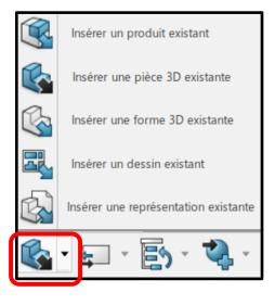
Dans le fichier «200 Voiturette-Train de roues», transférez les 3 pièces (copier-coller ou bien insérer une pièce 3D existante) que vous allez assembler pour ce sous-ensemble (axe de roue, anneau élastique et roue). Dans ce fichier, dupliquez (copier-coller) l'anneau élastique et la roue puis réalisez l'assemblage du sous-ensemble.
